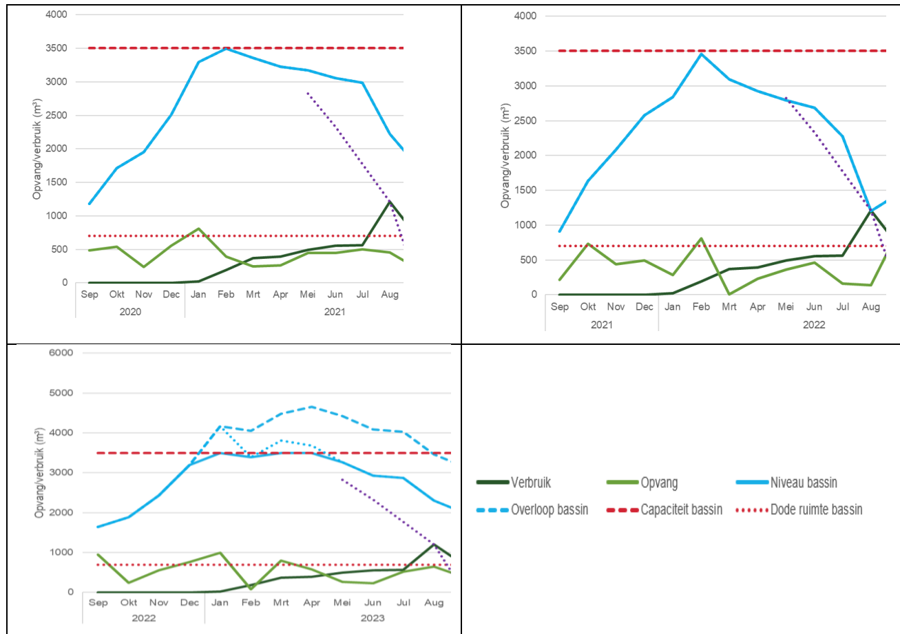
Figuur 4: Simulatie in laatste 3 jaar van paprikateelt op PCH met bassin van 3500 met in 2021 en 2022 jaren zonder tekorten of overlopen en in 2022 en in 2023 zonder tekort, maar met een overschot.
