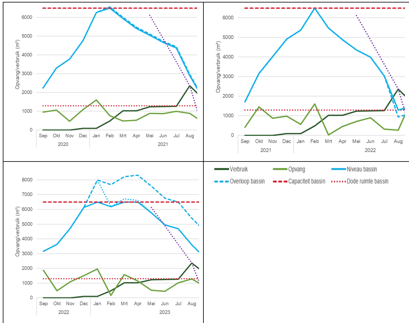
Figuur 5: Simulatie in laatste 3 jaar van onbelichte tomatenteelt op PCH met bassin van 6500 met in 2021 en 2022 jaren zonder tekorten of overlopen en in 2023 zonder tekort, maar met overlopen en met een overschot.
