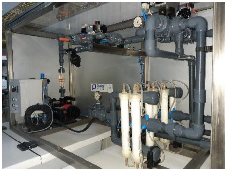
Figuur 5a en 5b: Detail van de installatie met filtermembranen die eenmalig gebruikt werden in de humane geneeskunde voor nierdialyse.
