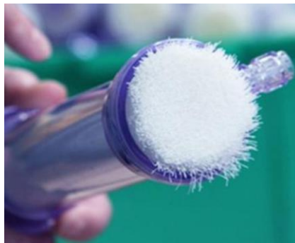
Figuur 5a en 5b: Detail van de installatie met filtermembranen die eenmalig gebruikt werden in de humane geneeskunde voor nierdialyse.
